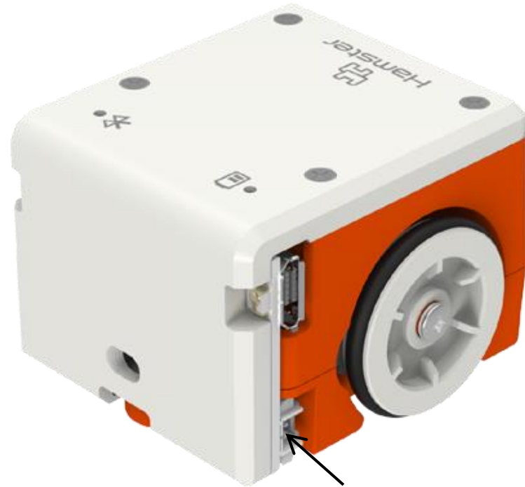
외부 입출력 단자 (포트A, 포트B) 디지털 입력, ADC 입력 디지털 출력, 아날로그(PWM) 출력 아날로그 서보 제어 출력
