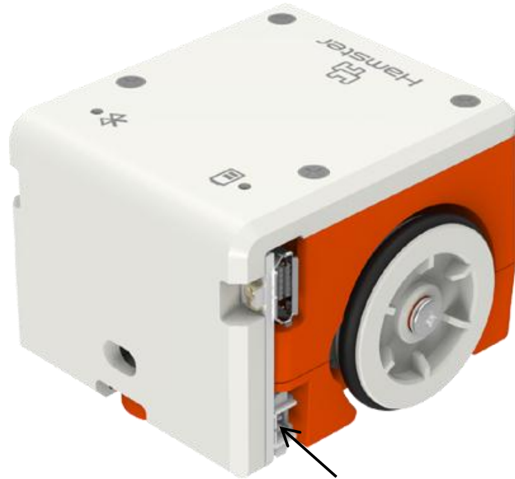
외부 입출력 단자 (포트A, 포트B) 디지털 입력, ADC 입력 디지털 출력, 아날로그(PWM) 출력 아날로그 서보 제어 출력
